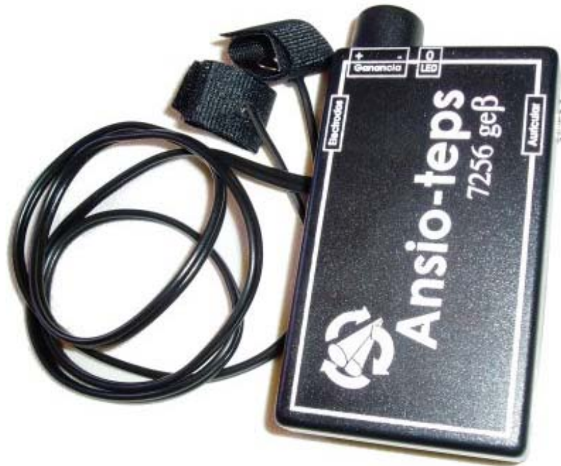
Figura 7.5. Ansio-teps, instrumento para proporcionar feedback de la actividad eléctrica
