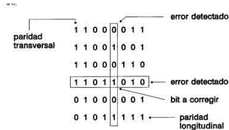
Figura 5.3 Corrección de un bit erróneo por doble detección de paridad en sentido horizontal y vertical.
