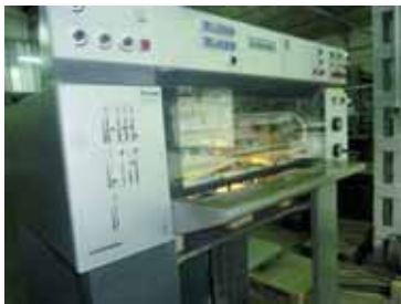
Pupitre de mandos de salida. Fuente: DIN Impresores
