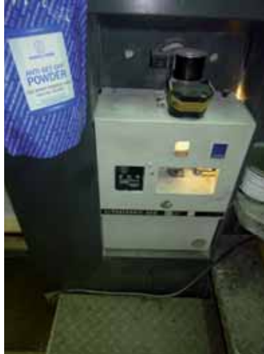
Sistema de aporte de polvos antimaculantes Fuente: DIN Impresores
