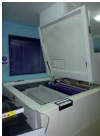
Ejemplo de resguardos móviles asociados a dispositivos de enclavamiento en procesadoras de pre-impresión. Fuente: DIN Impresores
