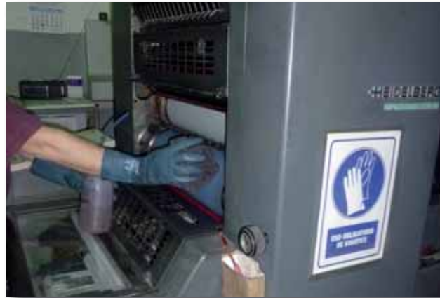
Limpieza manual de rodillos no desmontables de máquina offset.
