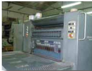
Pupitre de mandos principal en un cuerpo de impresión. Fuente: DIN Impresores
