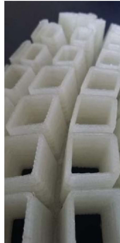
Izquierda: Estructura ergonómica generada mediante diseño computacional y producida por fabricación aditiva mediante el modelado por deposición fundida.
