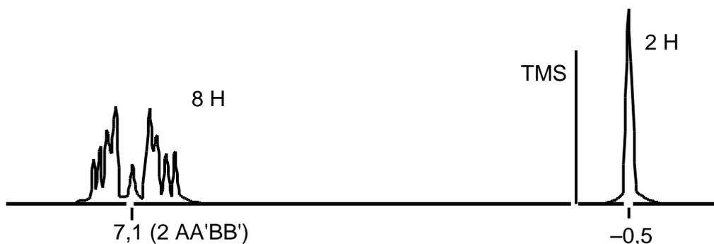
La presencia de un sistema AA'BB' en la región de los protones aromáticos que integra para 8 H y de un pico único correspondiente a 2 H a campos altos permite eliminar la estructura asimétrica (1), para la cual los dos protones del puente serían anisócronos y el sistema a campos bajos AA'BB'CC'DD'.
