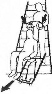
**2** Primeramente desplácelo hacia delante y descanse el patín sobre los dos bordes de la escalera. Deslice el agarre a la parte superior del asidero.
