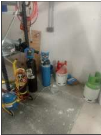
13 Botellones de gases sin fijar
