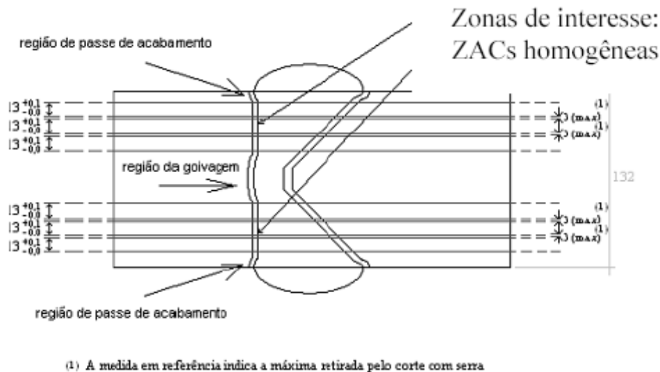
Fig. 2. Indicação do posicionamento para a retirada de barras das seções retangulares transversais à progressão de soldagem [13].
