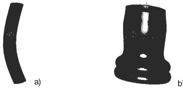
Fig. 2. Modos de instabilidade plástica de tubos sujeitos a compressão axial; a) Instabilidade, b) Instabilidade local.
