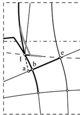
Fig. 3. Retraso en el inicio del contacto producido por el rebaje del diente conducido.
