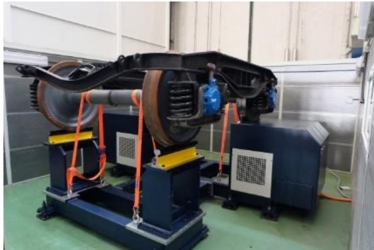
Fig. 1. Banco de ensayos de bogies utilizado.
