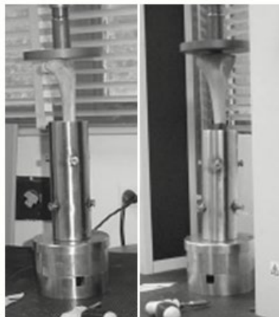
Fig. 3. Ensayo de hueso cadavérico (Izquierda) y sintético (derecha). [4]
