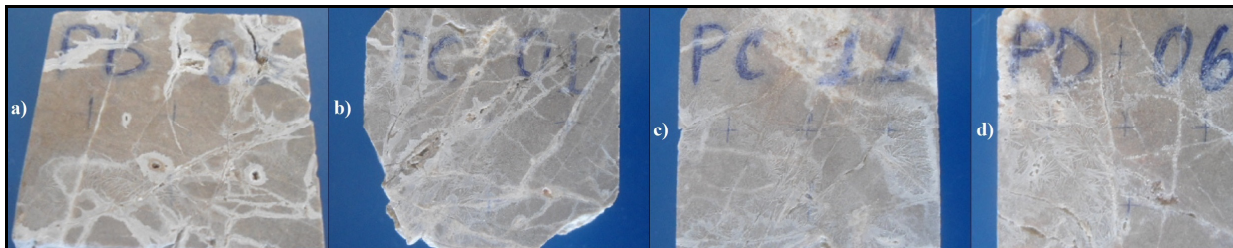
Fig. 9. Eflorescencias en las probetas: a) Probeta PB03; b) Probeta PC01; c) Probeta PC12; d) Probeta PD06.
