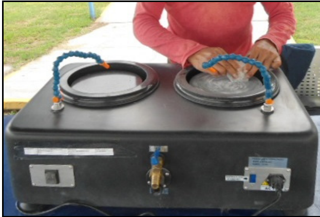
Fig. 3. Fotografía del lijado de probetas.
