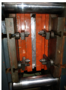
Fig. 2. Forma como o molde e fixado na máquina.
