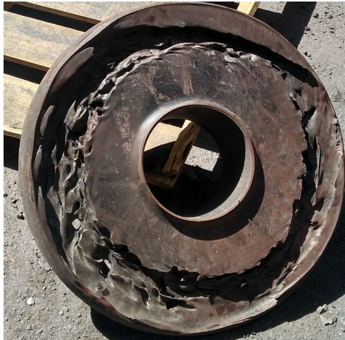
Fig. 4. Revestimento após falha.
