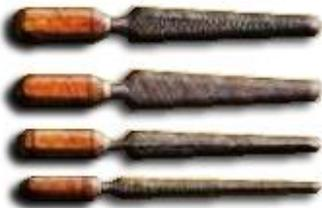
Únicamente se utilizarán limas provistas de mango liso asegurado mediante una abrazadera. En ningún caso hará uso de las mismas como palanca o punzón ni se golpearán con el martillo.
