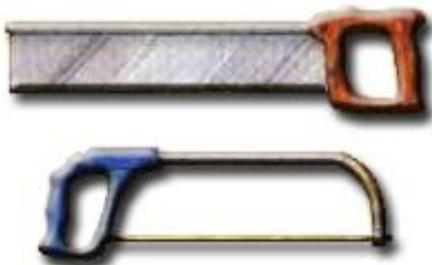
Los trabajos con sierras se llevarán a cabo con el material correctamente sujeto, sin serrar con demasiada fuerza y rapidez para evitar el doblaje o rotura de la hoja.
