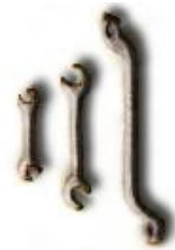
Deberá utilizarse la llave del tipo y calibre adecuados a cada trabajo tratando de lograr un correcto ajuste de la tuerca y una disposición perpendicular al eje del tornillo.
