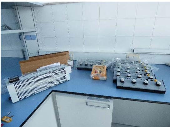
Cajas de 4 décadas de resistencia, de capacidades, reóstato lineal
